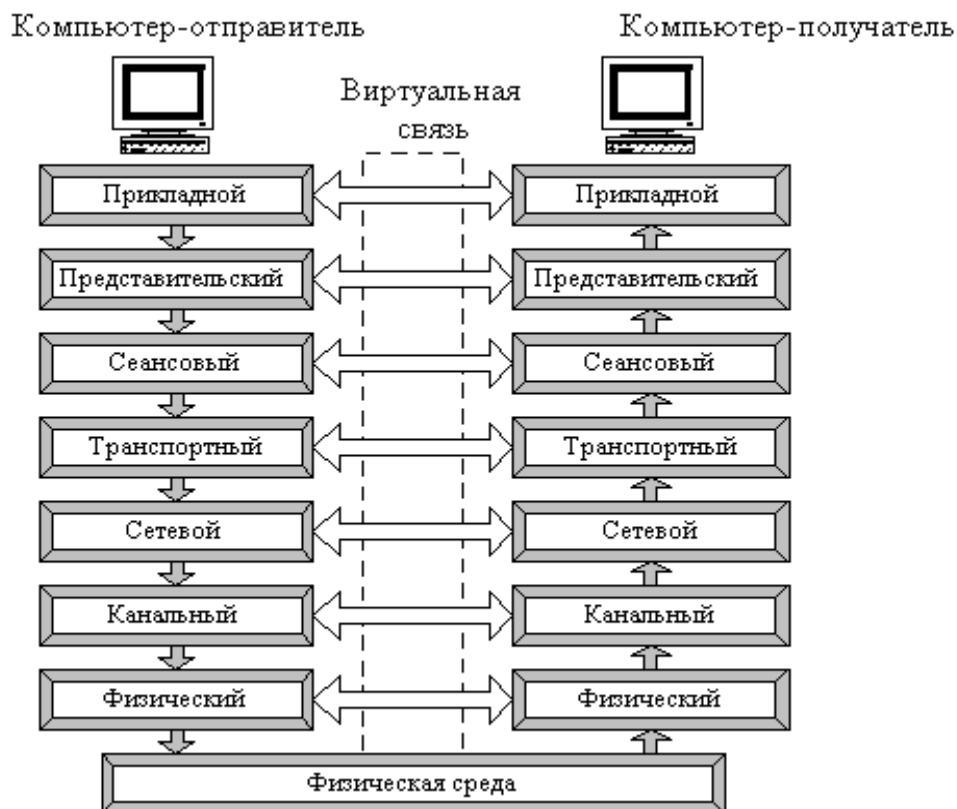
Рисунок.2. Схема взаимодействия компьютеров в базовой эталонной модели OSI
