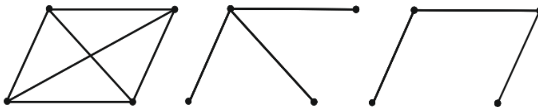
Рис. 1.7. Граф и два покрывающих дерева
