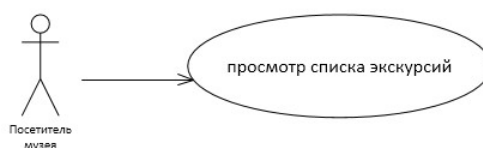
Рисунок 4.5 - Пример графического представления отношения направленной ассоциации между актером и вариантом использования
